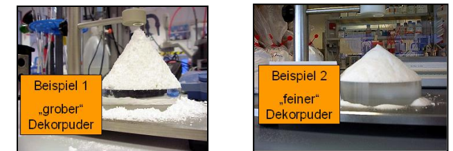
Abbildung 2: Ergebnis Rieseltest bei groben und feinen Dekorpuder
