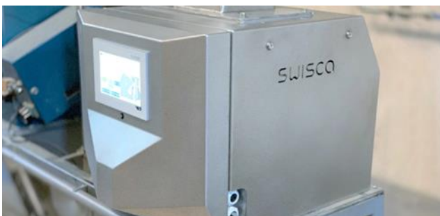
Abbildung 3: Mengenregler mit Servoantrieben schliessen bei Stromausfall kontrolliert und senden die Daten noch zur Cloud.
