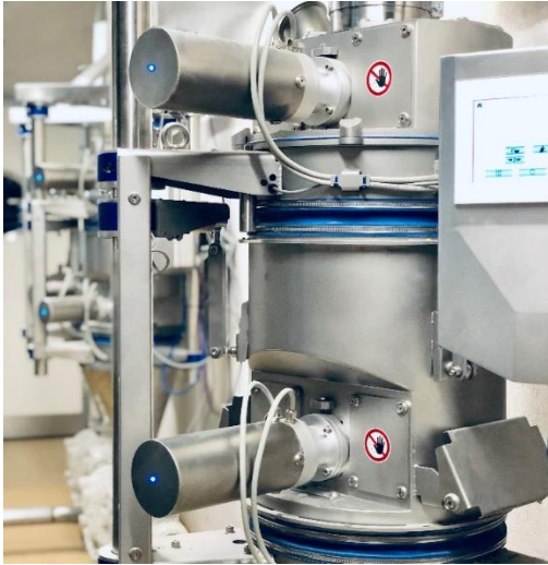
Abbildung 2: Moderne Waagen mit Servo-Antrieben sparen auch Energiekosten, weil keinerlei Druckluft mehr benötigt wird.
