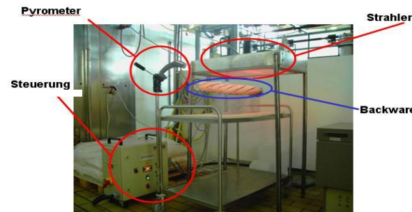
Abbildung 3: Versuchsaufbau der Entkeimungsanlage
