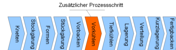
Abbildung 4: Prozessablauf mit zusätzlichem Vorkühlen
